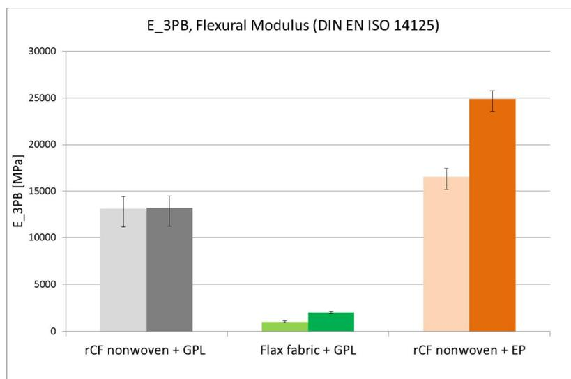
**Figure 39: Flexural Modulus**
